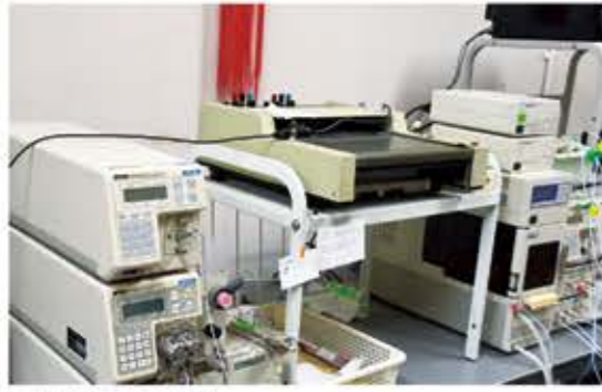
高速液体クロマトグラフ 〔固定相(ゲル)と移動相(溶媒)を用いて成分を分離分析する機器〕
