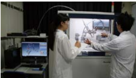
X線結晶構造解析装置を用いた分子構造の解明
